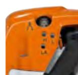
Bei STIHL Motorsägen und Hoch-Entastern mit manueller Kraftstoffpumpe wird der Startvorgang erleichtert und die Anzahl der Anwerfhübe reduziert. Wird der Pumpenbalg gedrückt, füllt sich die Regelkammer des Vergasers mit Kraftstoff. Damit steht beim Anwerfen sofort genügend Kraftstoff zur Bildung eines zündfähigen Luft-Kraftstoff-Gemisches zur Verfügung und es sind deutlich weniger Anwerfhübe erforderlich.
