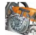
Die Vorabscheidung in STIHL Motorsägen dient zur Vorreinigung der Luft und entlastet dadurch die nachfolgenden Filtersysteme spürbar. Die angesaugte Luft wird zunächst durch das Lüfterrad in Rotation versetzt.
