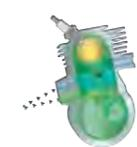
Der STIHL 2-MIX-Motor ist leistungsstark und sparsam zugleich. Die Trennung von Abgas und Frischgas minimiert die Spülverluste und erhöht dadurch die Leistung und reduziert gleichzeitig den Verbrauch.
