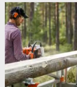
Spezielle Längsschnitt-Sägekette für den Einsatz auf Längsschnitt-Geräten sowie mobilen Kleinsägewerken. Halbmeißelzahnkette mit hoher Schnittqualität bei niedrigem Vibrationsniveau und weichem Schneidverhalten. Für mehr Informationen besuchen Sie Ihren Fachhändler.
