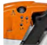
Bei STIHL Heckenschere und Heckenschneider mit manueller Kraftstoffpumpe wird der Startvorgang erleichtert und die Anzahl der Anwerfhübe reduziert. Wird der Pumpenbalg gedrückt, füllt sich die Regelkammer des Vergasers mit Kraftstoff. Damit steht beim Anwerfen sofort genügend Kraftstoff zur Bildung eines zündfähigen Luft-Kraftstoff-Gemisches zur Verfügung und es sind deutlich weniger Anwerfhübe erforderlich.
