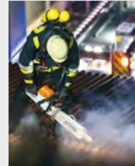
Spezial-Sägekette für härteste Einsätze von Feuerwehren, Rettungsdiensten und Technischem Hilfswerk (z. B. Holz mit Nägeln, Verbundmaterial und Panzerglas). Schneidezähne mit vollflächiger Aufpanzerung aus schlagzähem Hartmetallplatten.
