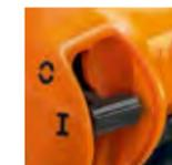
Nach dem Abschalten springt der Bedienebel selbstständig in seine Betriebsposition zurück. Die warme Maschine kann dadurch direkt wieder neu gestartet werden.
