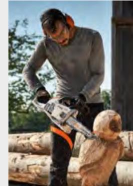
Spezial-Sägekette für Holzschnitzer. Vibrationsarm, sehr gute Schnittleistung, durch gekürztes Zahndach kein Drücken beim Stechvorgang nötig, erreicht höhere Stechgeschwindigkeit als herkömmliche 1/4"-Sägeketten.
