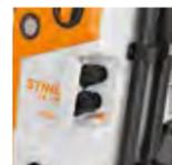
Die integrierten Düsenhalter unter der Fronthaube dienen der sicheren und vor Schmutz geschützten Aufbewahrung von Rotor- und Flachstrahldüse. So sind beide Düsen rasch verstaut und im Anwendungsfall schnell zur Hand.
