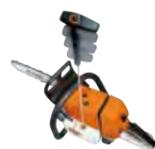
Als Folge des Kompressionsdruckes treten beim Anwerfen von Verbrennungsmotoren ruckartige Belastungen auf. Das Dämpfungselement im Spezialanwerfgriff ElastoStart nimmt entsprechend dem Verlauf der Kompression abwechselnd Kraft auf und gibt sie wieder ab. Dies bewirkt einen gleichmäßigen Anwerfvorgang.
