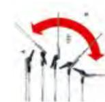
Der Messerbalken lässt sich stufenweise um bis zu 130° (HL 91), bis zu 145° (HL 94, HLA 135), bis zu 115° (HLA 66, HLA 86), bis zu 135° (HLA 56),
